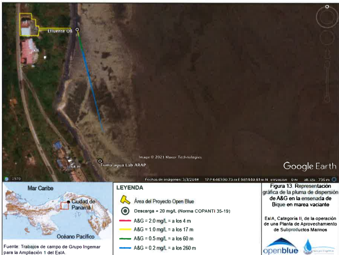
Figura 12) Simulación de las concentraciones de Aceites y Grasas en función de la distancia en marea vaciante
