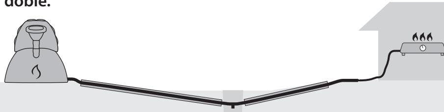
**No debe haber dobleces en U a lo largo de la tubería, para evitar que se acumule agua y bloquee el paso del gas.**
