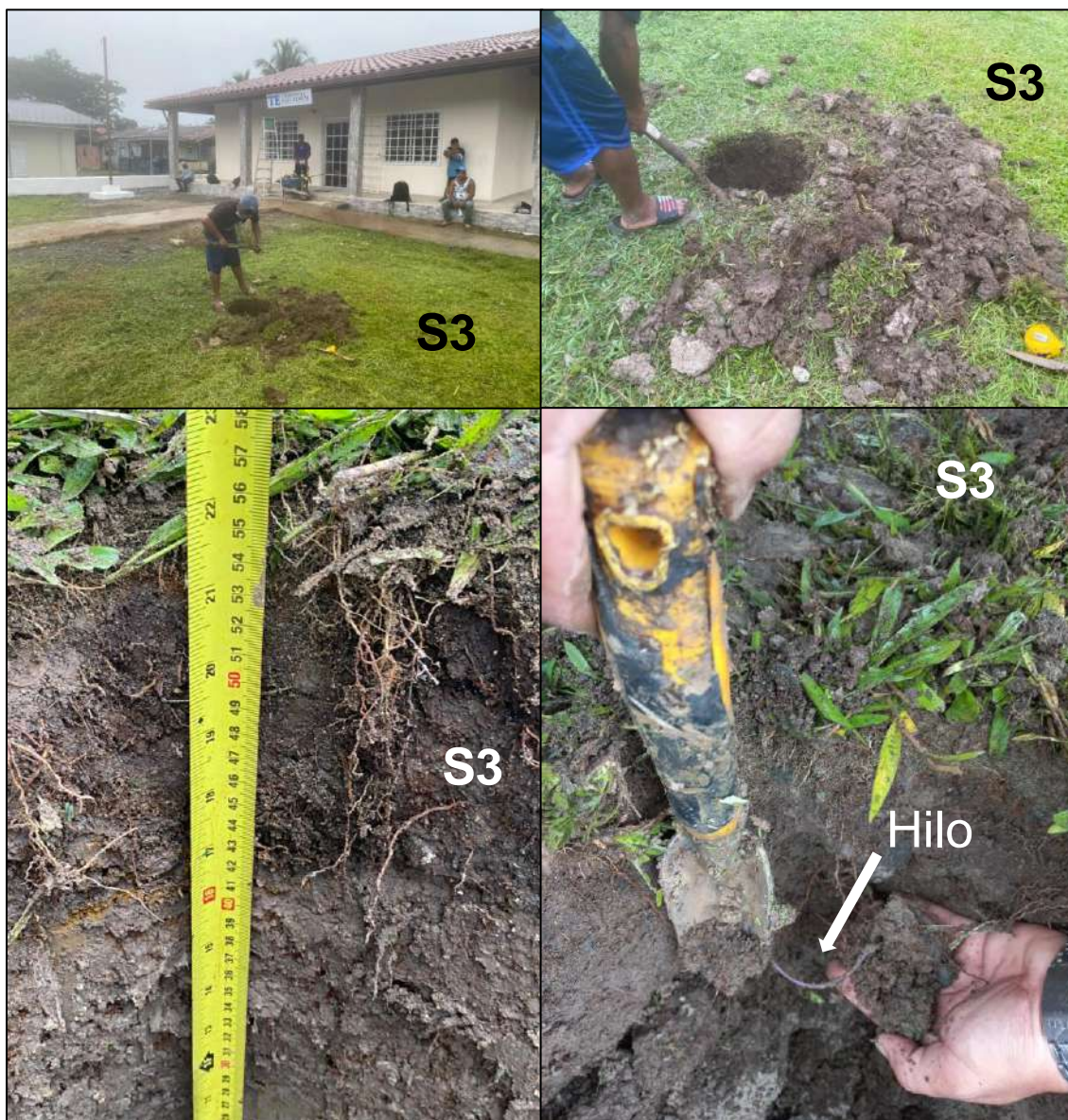
Figura 3. Excavación del Sondeo 3 y su perfil estratigráfico
