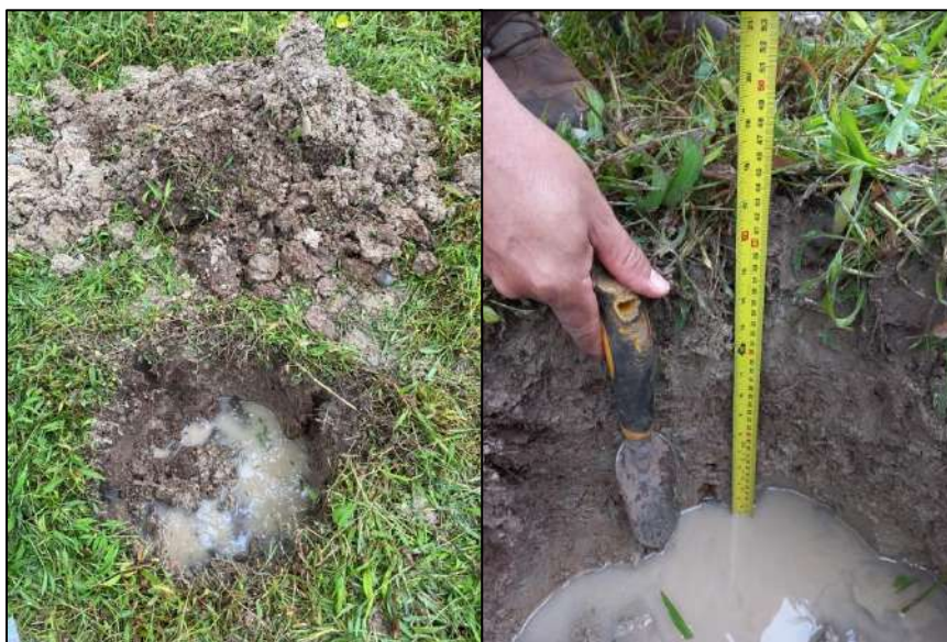
Figura 4. Perfiles estratigráficos y fotos enseñando el agua encontrada en los pozos 1 y 2
