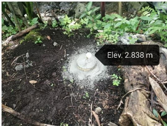
Monumento de referencia de niveles (BM) con elevación asumida de 2.838 m.
