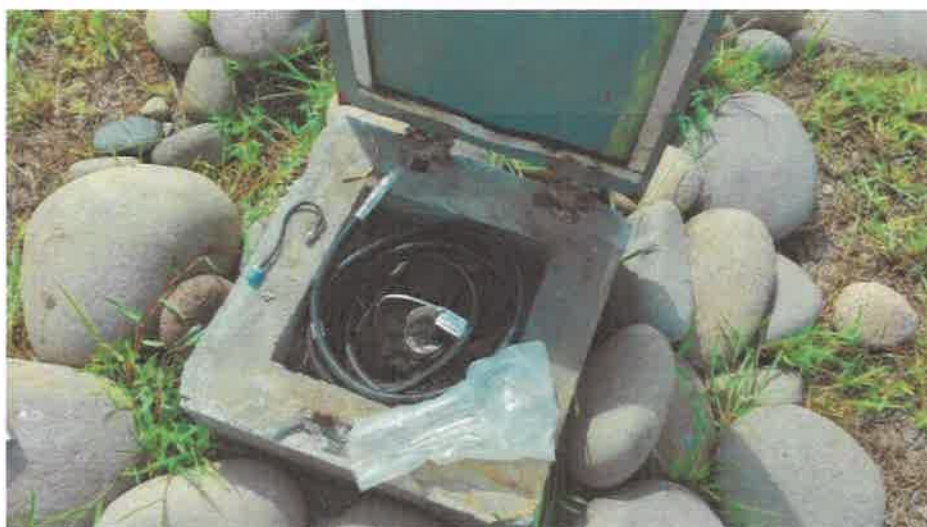
Figura N° 4 – Uno de los inclinómetros del canal de aducción. Fuente: Altermegy, S.A.
