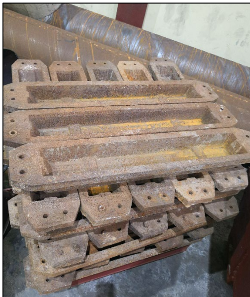
Figura 5-12. Moldes para los lingotes de aluminio
