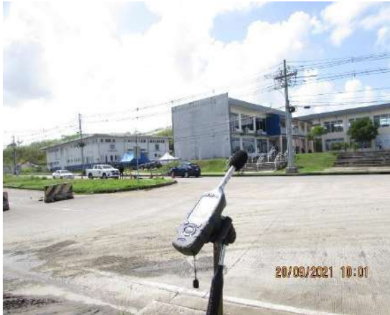
Imágenes 4.1 y 4.2. Sonómetro utilizado durante la medición de ruido ambiental, en el Punto 1
