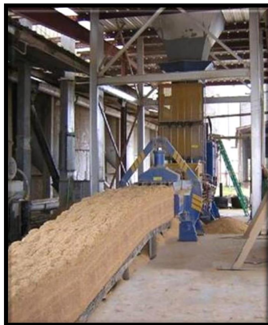
Figura N° 5. Especificaciones técnicas del sistema automático de compactado y prensado de la cascarilla de arroz – Modelo H-80/65AR para el proyecto “Galera para almacenamiento de cascarilla” Promotor HERMANOS PALACIOS, S.A.
