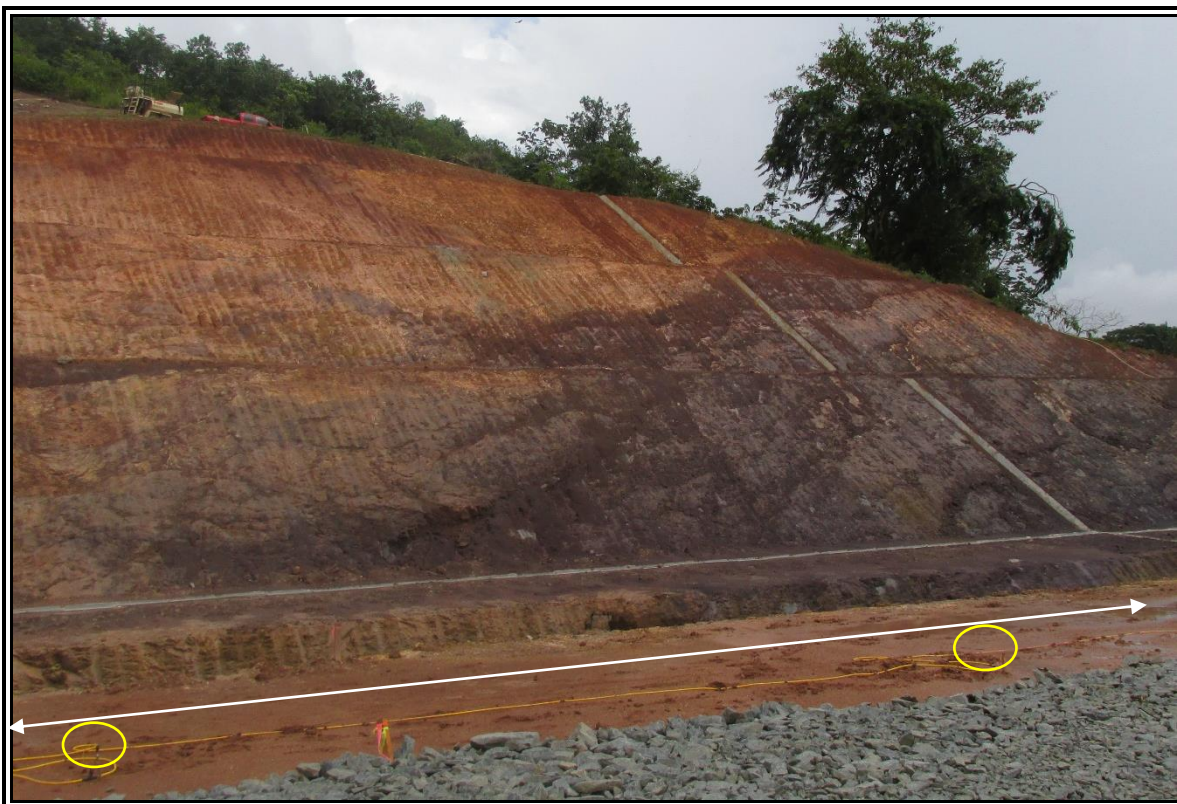
Figura 4. Disposición de electrodos de la Tomografía 2.
