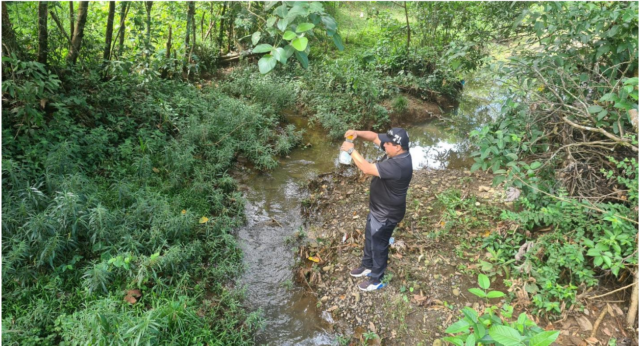
Toma de muestras para análisis físico químicos y bacteriológicos en el drenaje superficial de temporada, muy cerca del puente de Los Toretos, Soná.
