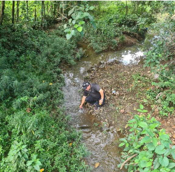
Toma de muestras para análisis físico químicos y bacteriológicos en el drenaje superficial de temporada, muy cerca del puente de Los Toretos, Soná.
