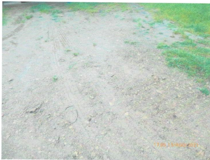
Foto 9. Vista existente del suelo con gravillas y arena continental que será afectada durante la excavación profunda.
