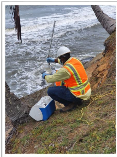
Imagen No.3: evidencia de toma de muestras de calidad de agua marina / costera por laboratorio CORPORACION QUALITY SERVICES
