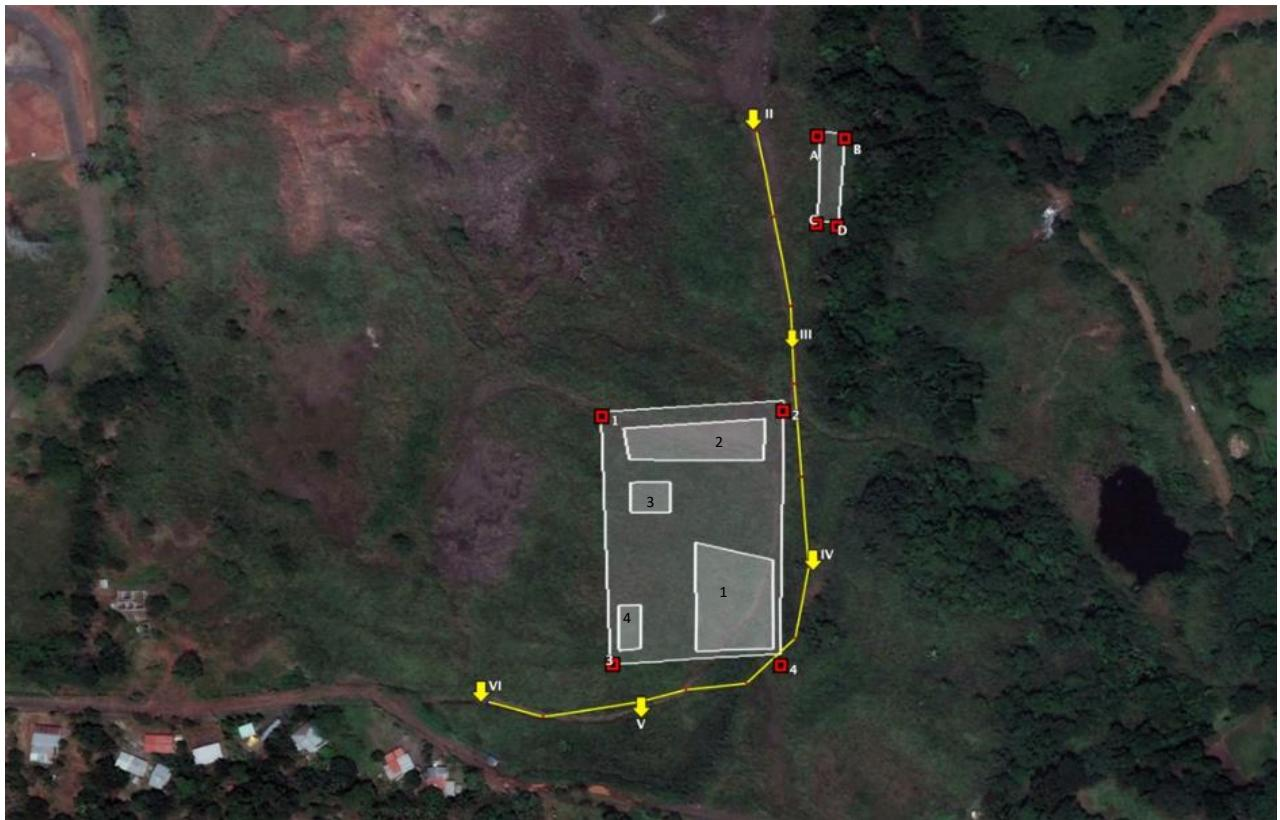
1: Almacenamiento, 2y3: Planta Trituradora 4: Oficinas (prefabricadas Container)
