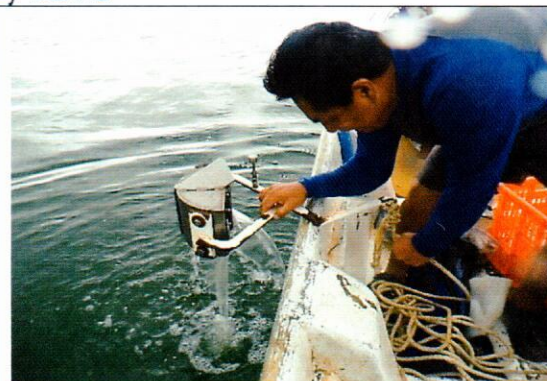
Foto 3. Colecta de muestras de Bentos, empleando draga Ekman
