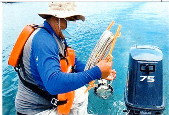
Foto 2. Colecta de Fito y Zooplancton con red tipo bongo
