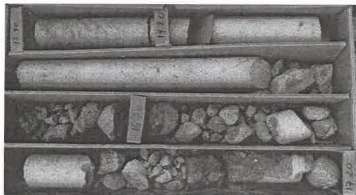
Figura 9. Testigo recuperado en la Unidad 2. Sondeo SPRC-01 entre 13.90 m y 17.20 m.
