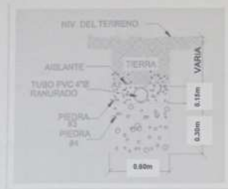
Fig. 3. Detalle de zanja para campo de filtración
