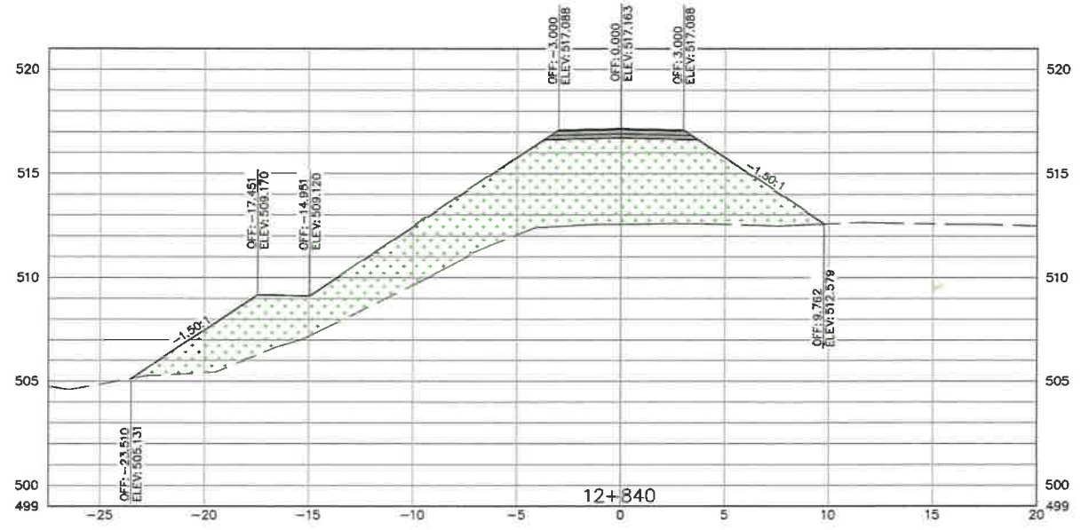
Figura 2. Sección 12+840 de Talud en Relleno
