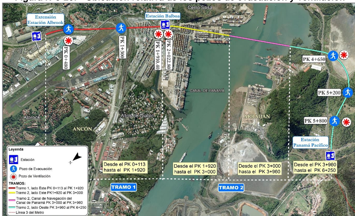
Figura N°5-20: Ubicación relativa de los pozos de evacuación y ventilación
