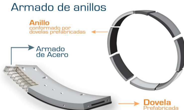
Figura N°5-6: Ejemplo de una dovela y un segmento de anillo
