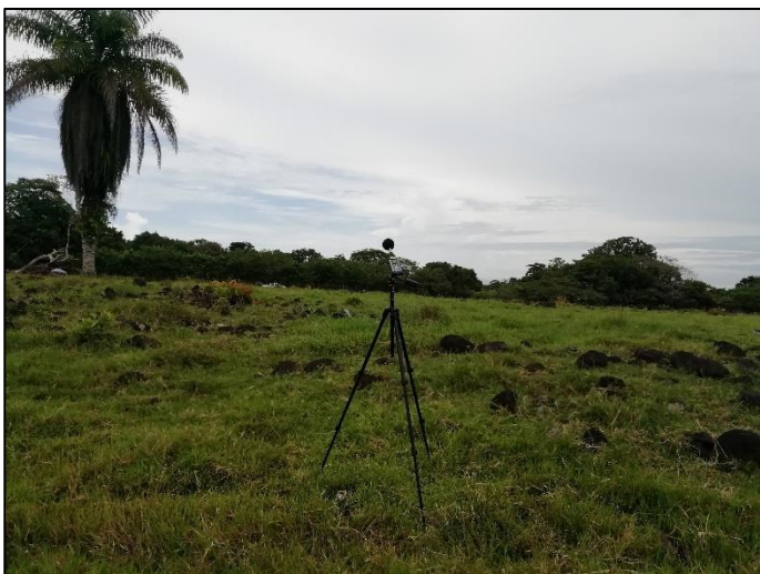
Fotografía 7: Medición diurna de Ruido Ambiental en punto 3, ubicado dentro del perímetro del Proyecto La Inmaculada.
