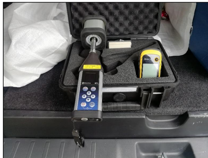
Fotografía 2: Equipos utilizados para la medición de ruido ambiental (Sonómetro SVAN 971, Pistófono de calibración SV33 y GPS Garmin).
