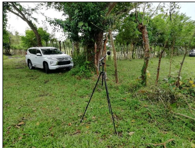
Fotografía 4: Medición diurna de Ruido Ambiental en Punto 1, ubicado en la entrada del Proyecto La Inmaculada.
