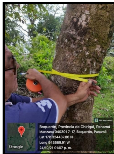
Fotografía 7-8 Medición de DAP con Cintas diamétricas
