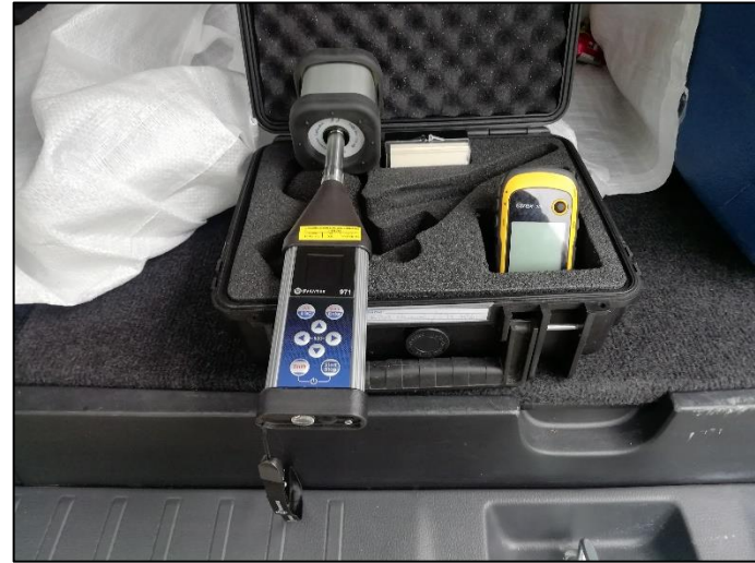
Fotografía 2: Equipos utilizados para la medición de ruido ambiental (Sonómetro SVAN 971, Pistófono de calibración SV33 y GPS Garmin).
