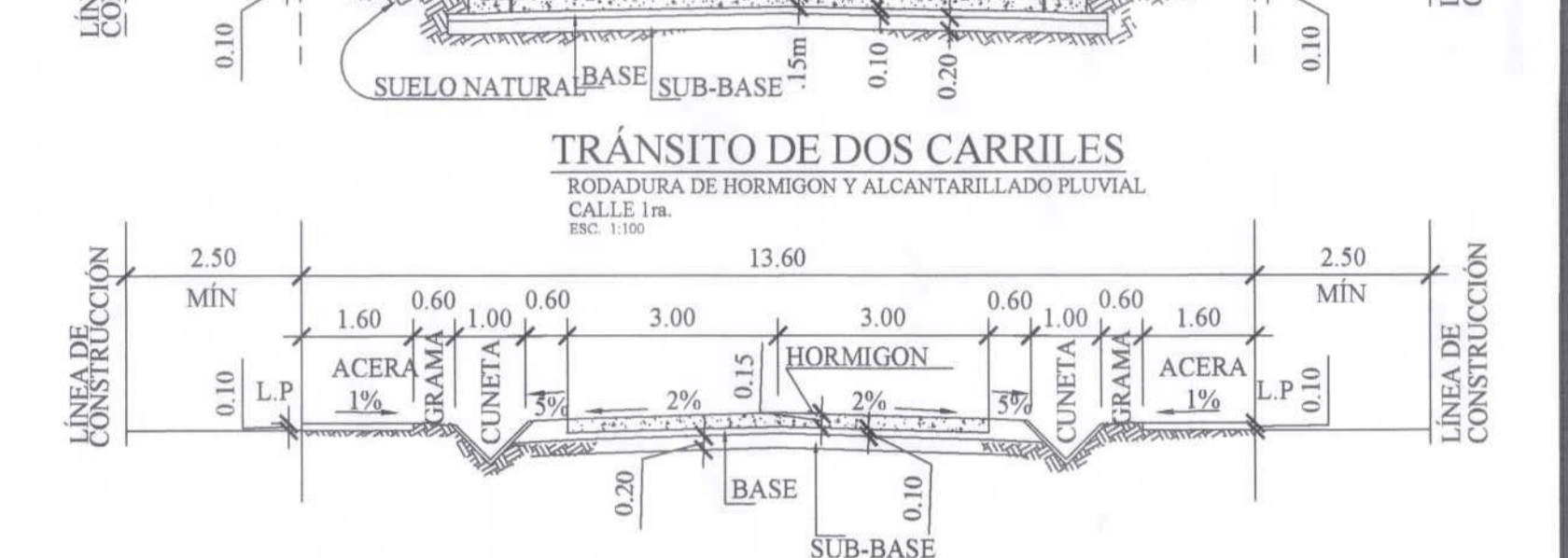
TRANSITO DE DOS CARRILES RODADURA DE HORMIGON Y CUNETAS PAVIMENTADAS CALLE 1ra., CALLE A, CALLE B, CALLE C, CALLE D. Esc.: 1:100
