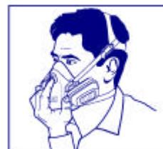
Coloque la palma de la mano sobre la válvula de exhalación y exhale con suavidad.
