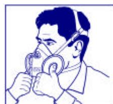
Presionar los pulgares en la parte central del filtro Serie 2000 o por la parte superior e inferior en el filtro 6035, inhalar con suavidad y mantener la respiración durante unos cinco o diez segundos.
