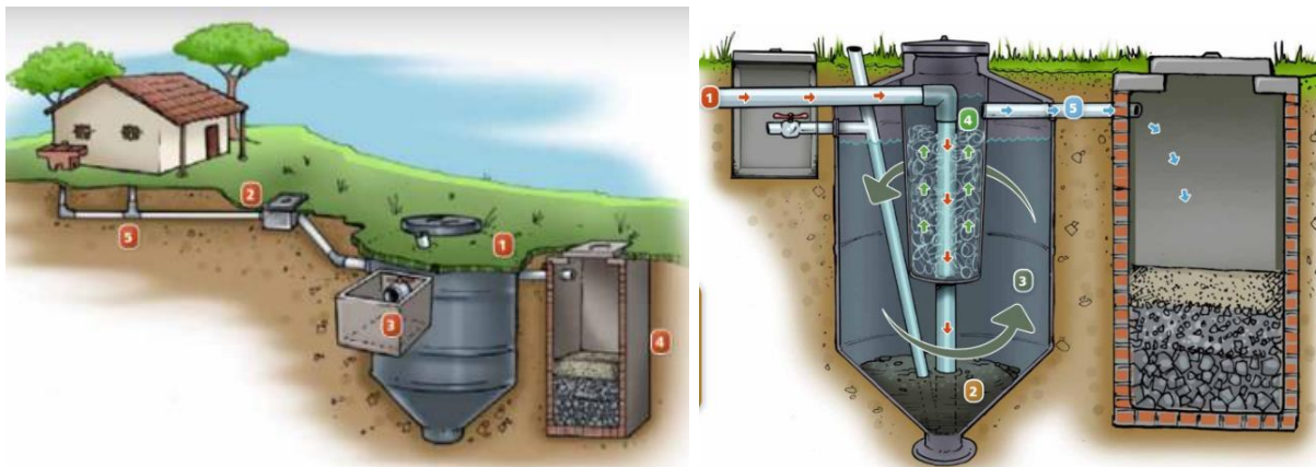
Figura 5.35. Esquema general de funcionamiento del biodigestor.
