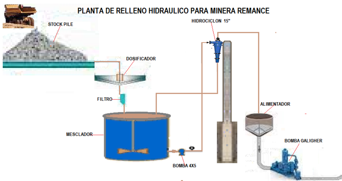
Figura 5.52. Esquema de Planta de Relleno Hidráulico.
