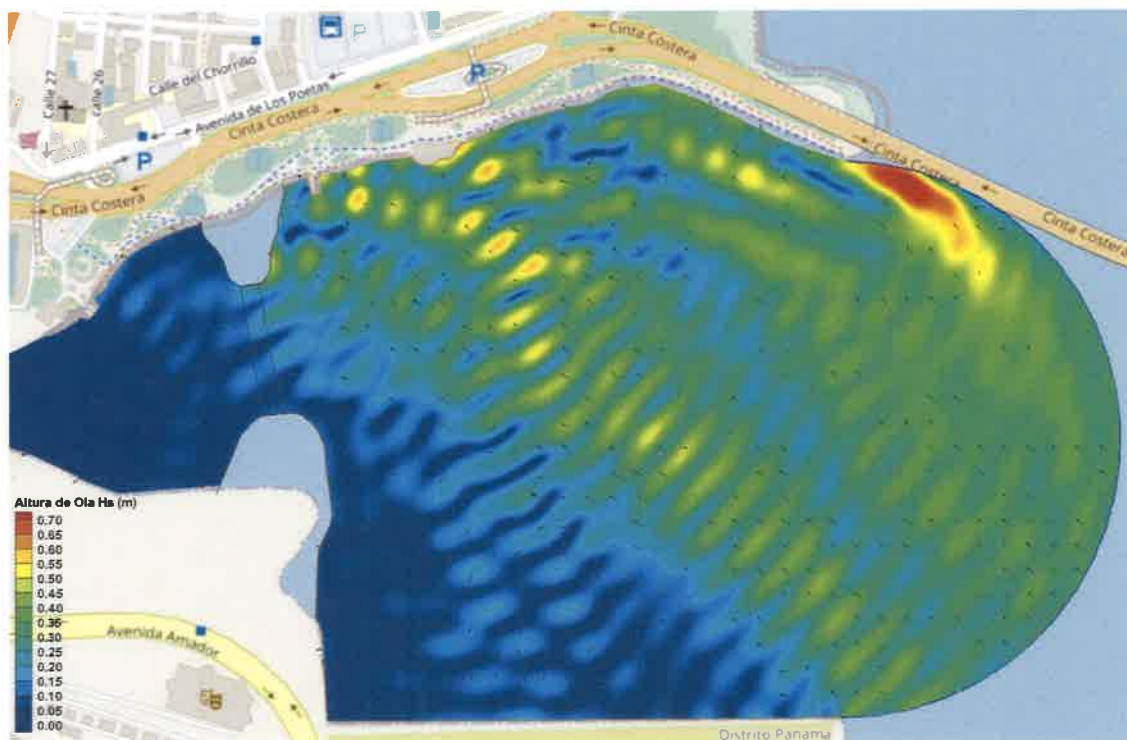
Figura 54 Resultados modelo detallado. Caso SSE3. Recurrencia 1 año. Con Puente
