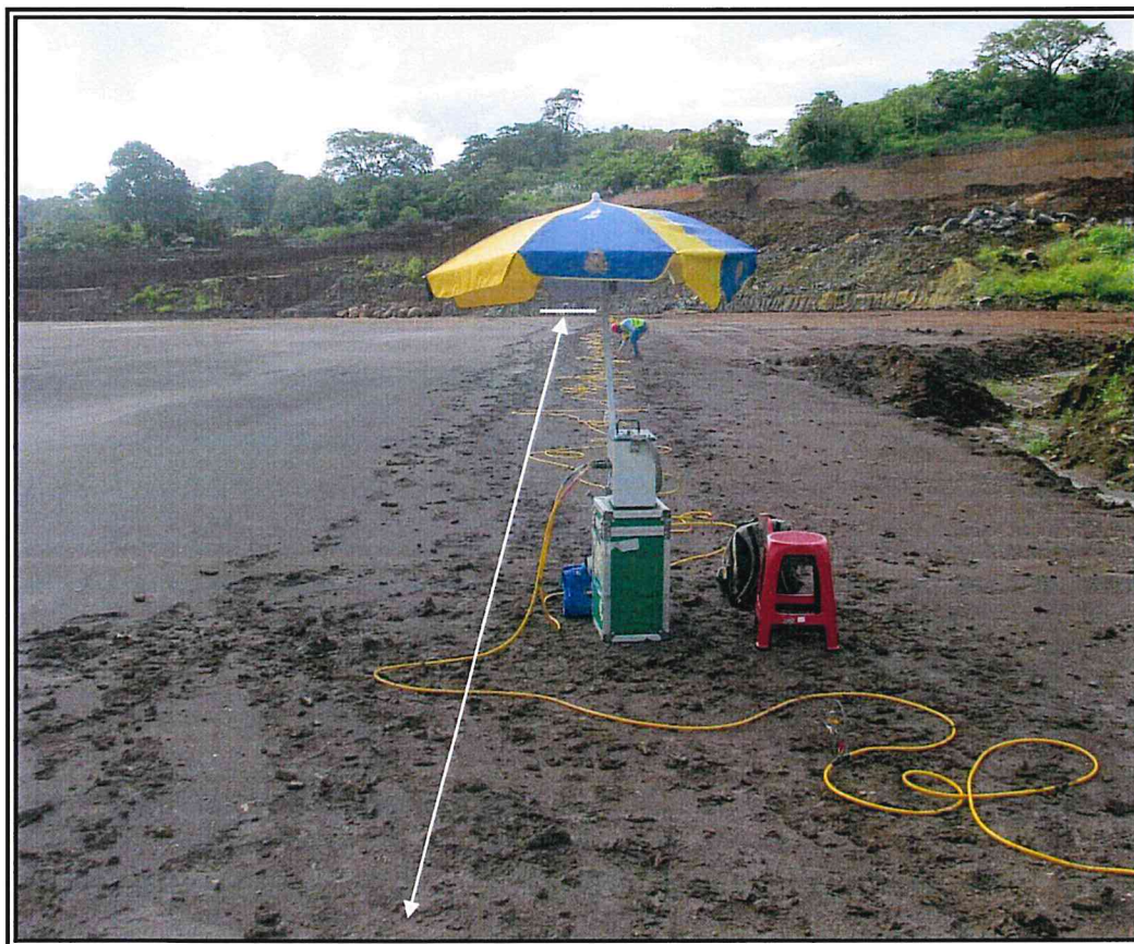
Figura 2. Disposición del centro y lado sur de la Tomografía 1. – Longitud total aproximada 200 metros
