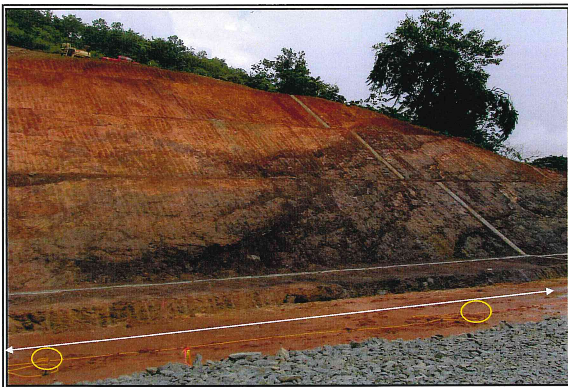
Figura 4. Disposición de electrodos de la Tomografía 2.
