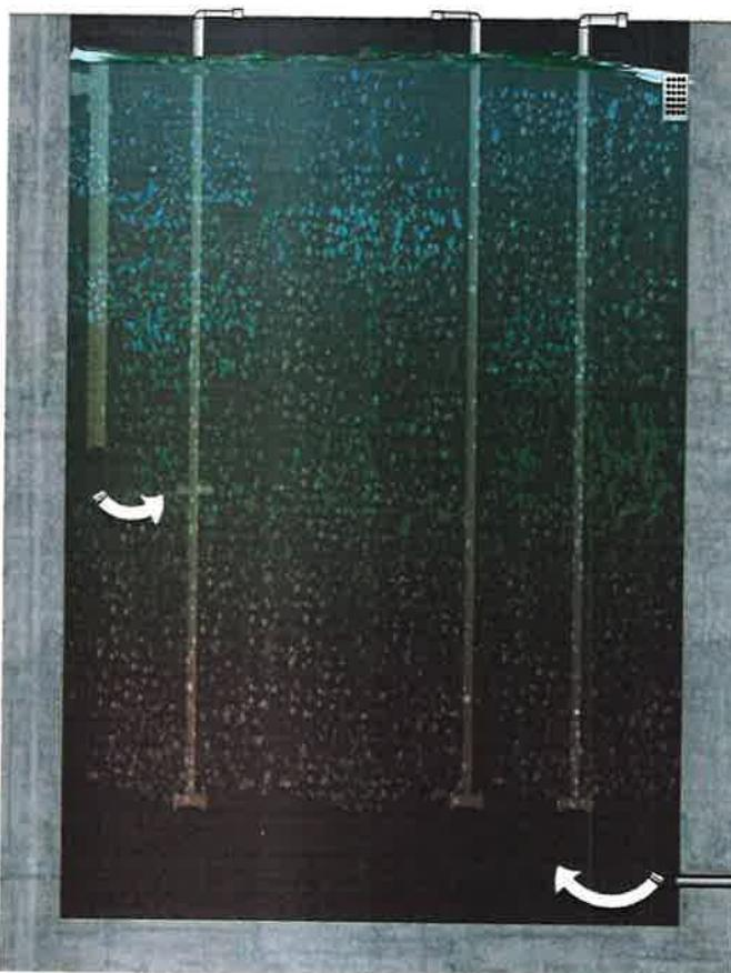
Un compresor de aire de tipo de desplazamiento positivo estará localizado fuera de la planta y conectará a los difusores *FlexAir* mediante un arreglo, que permita el fácil reemplazo de los elementos, sin necesidad de vaciar la cámara de aireación.
