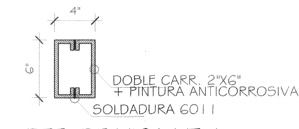
DET. DE VIGA VT-1 ESC. 1/10
