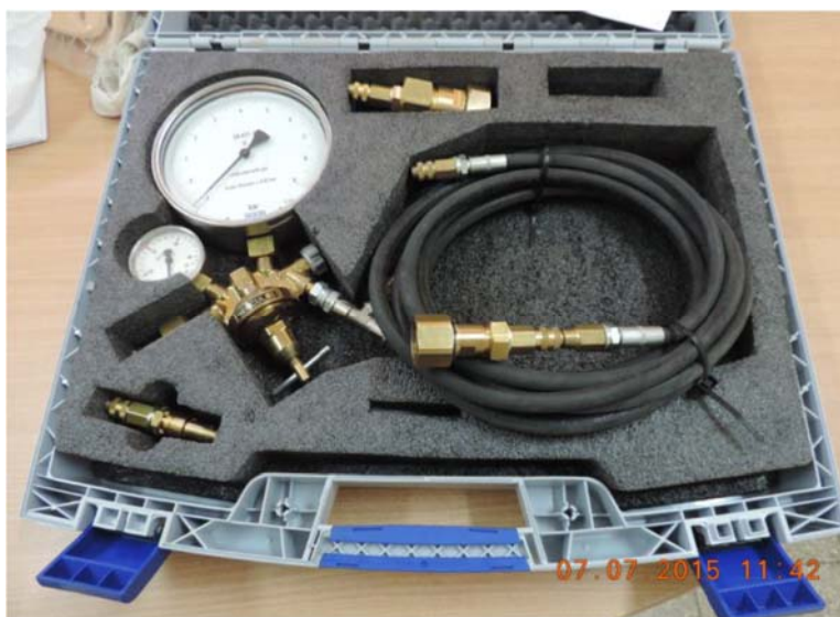
Fig.01 Equipo de llenado de gas \text{SF}_6
