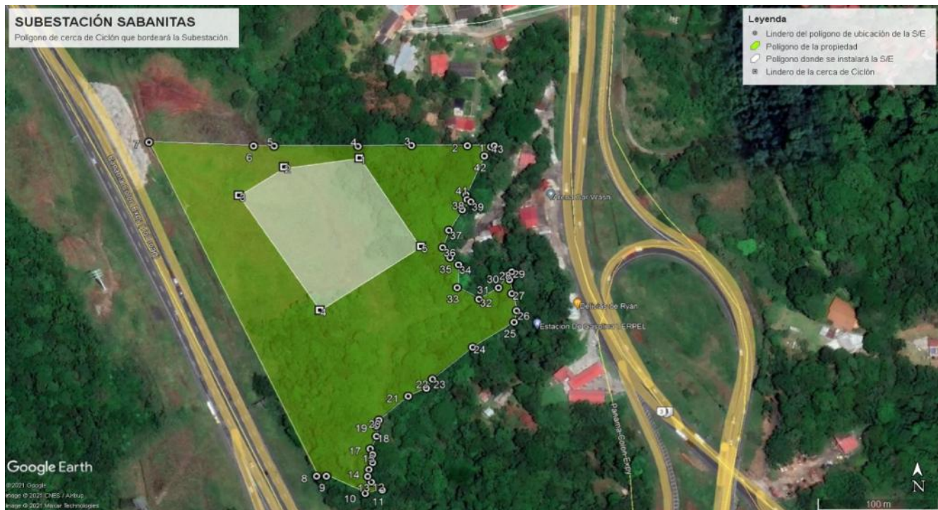
Figura 5.3. Imagen de satélite con el polígono de 1.12 ha delimitado por la cerca de Ciclón a ser construida para la Subestación eléctrica Sabanitas 230 kV.
