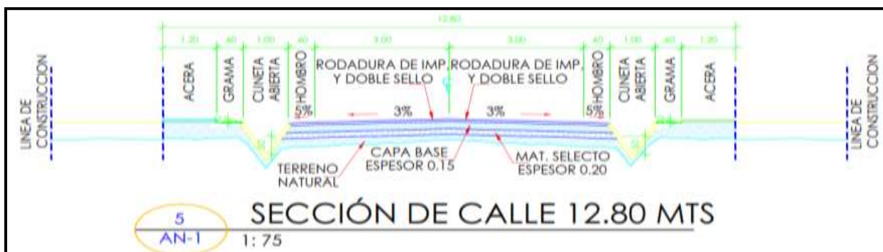
Ilustración 3. Detalle de sección de calles de 12.80 metros
