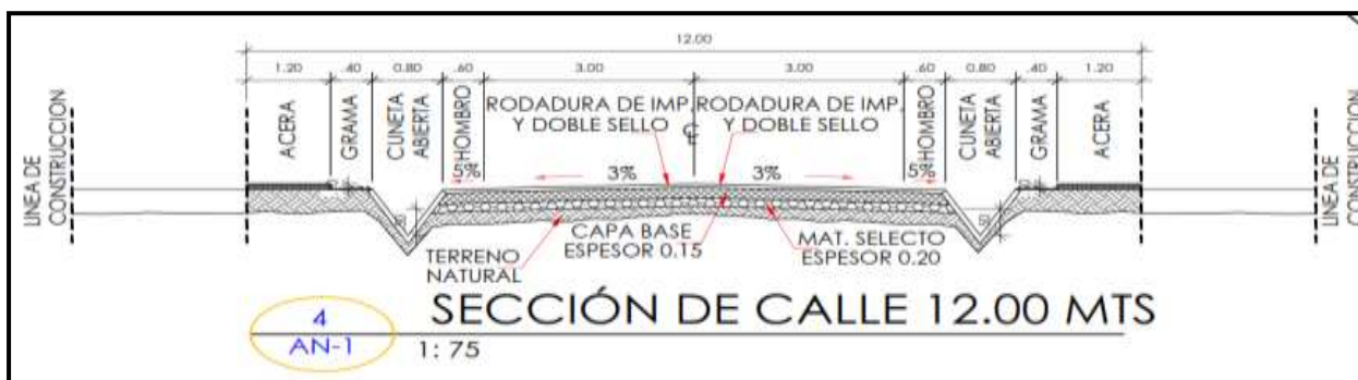
Ilustración 4. Detalle de sección de calles de 12.00 metros
