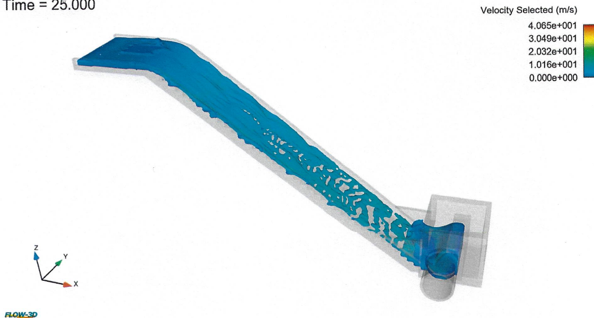
Figura 13 – Funcionamiento del derramadero y disipador de impacto
