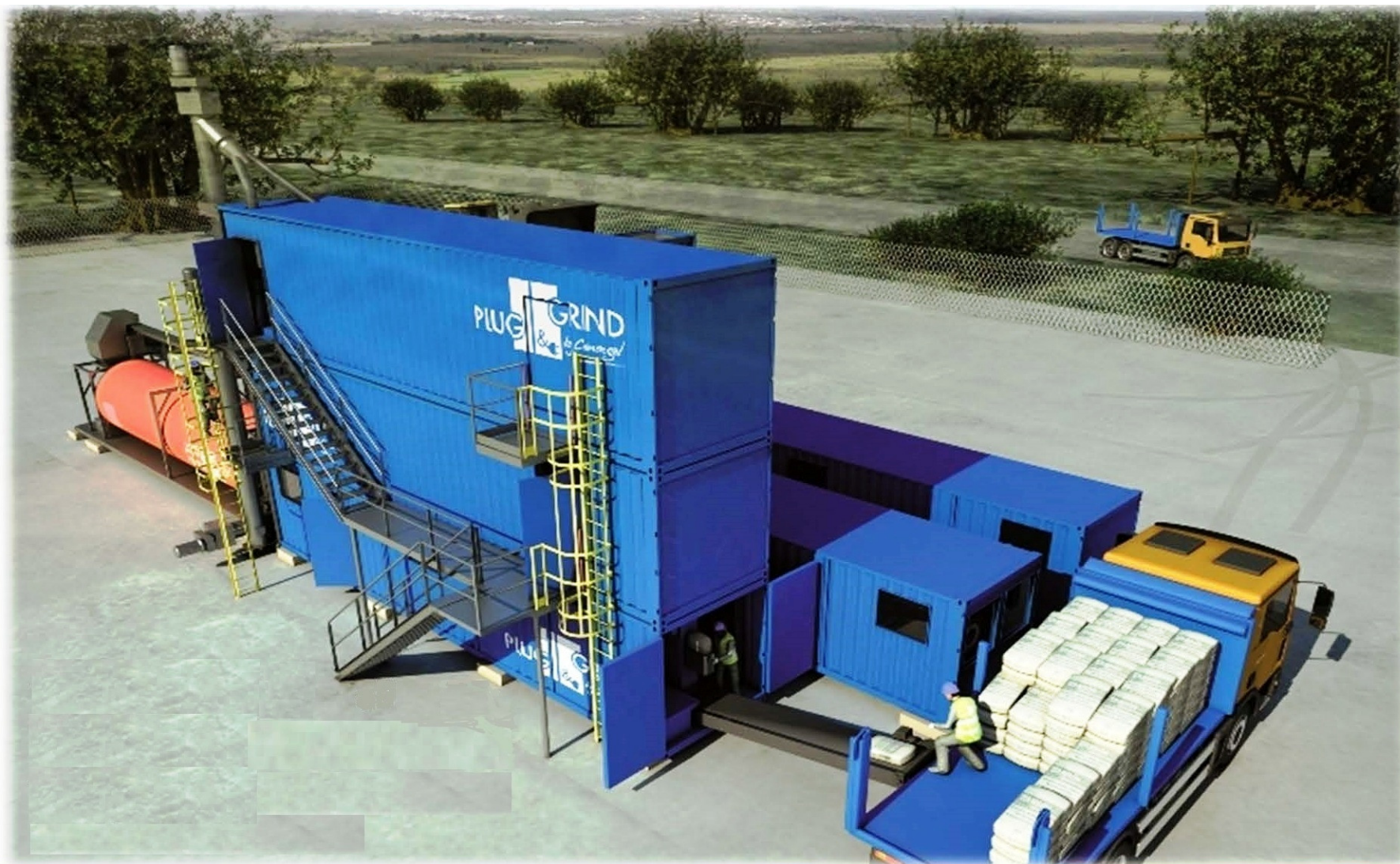
Ilustración 12 Isometría de la planta típica de moler Clínter bajo el diseño de Plug & Grid Fuente: www.cemengal.com
