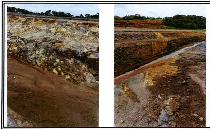
Figura 10 (a, b): A la izquierda (a), depósito de brecha alterada. Derecha (b), brecha de falla con azimuth 190.
