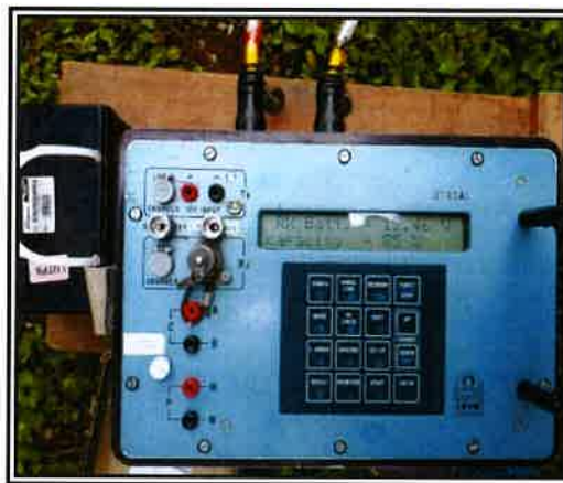
Figura 5. Toma de datos mediante el dispositivo Syscal.
