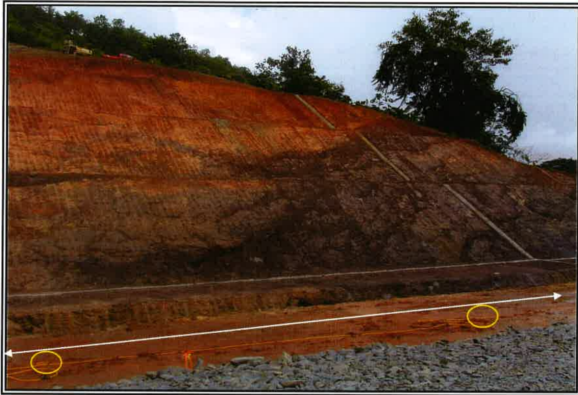
Figura 4. Disposición de electrodos de la Tomografía 2.
