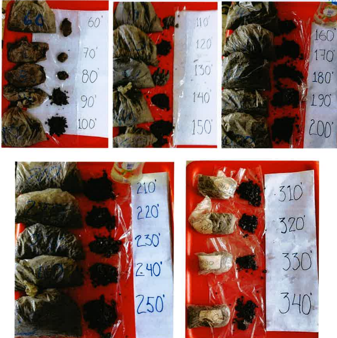
Muestras de recortes perforación y ordenamiento de los mismos, de los tramos 60-100 pies, 110-150 pies, 160- 200 pies, de 210- 250 y de 310- 340 del pozo PPA. Ver tramos 10-50 pies y 260- 300 pies en la página 33.
