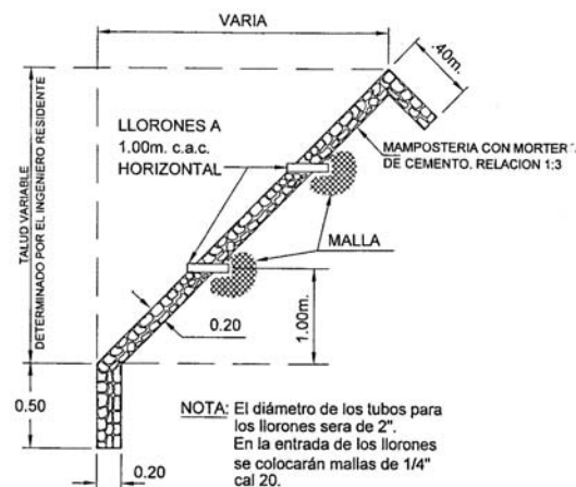
SECCION TIPICA DE ZAMPEADO
