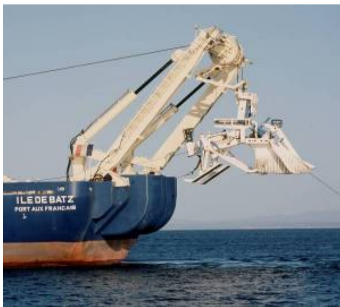
Figura 5-4: Arado colocado en la parte posterior (proa) del buque
