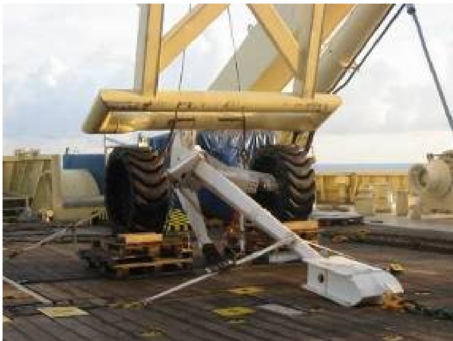
Figura 5-3: Rezón de perforación con ruedas
