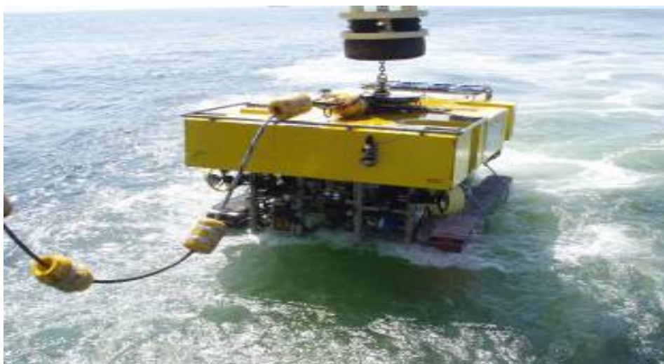
Figura 5-721: ROV navegable flotante
