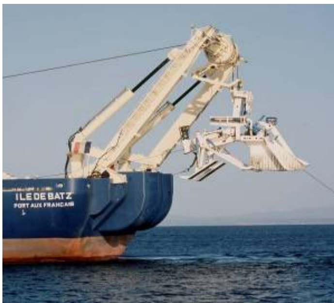
Figura 2.2-4: Arado colocado en la parte posterior (proa) del buque
