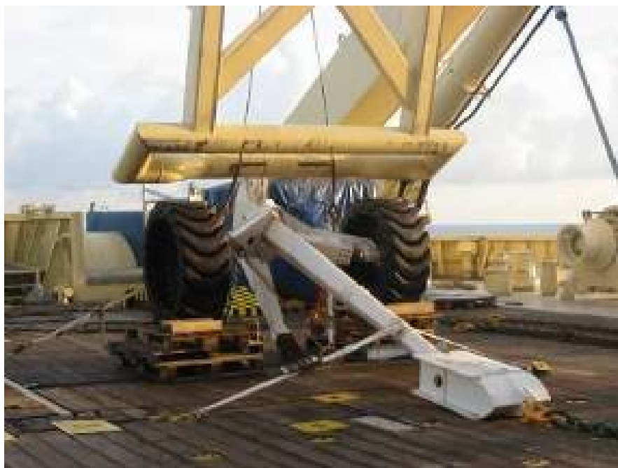
Figura 2.2-3: Rezón de perforación con ruedas
