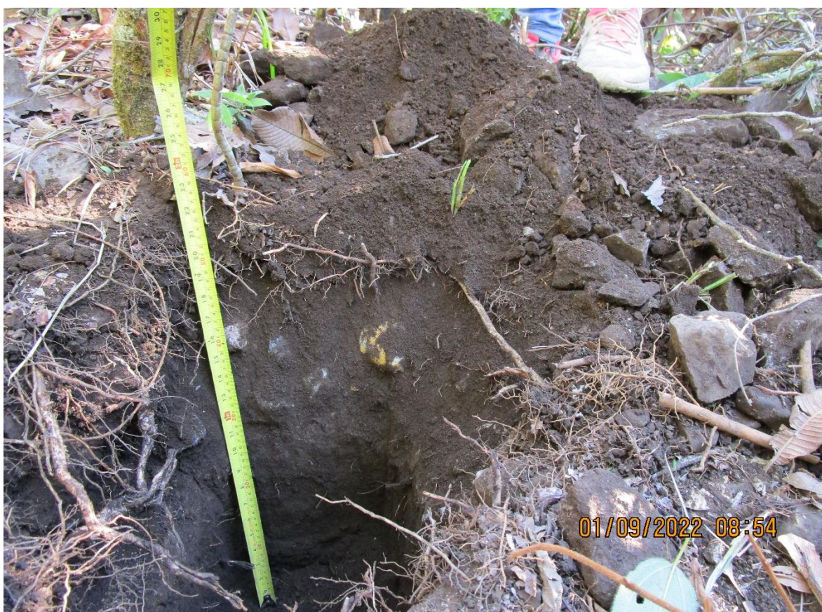
Fig. 29. Final de la excavación del PS 44. Nótese la presencia de piedras angulares en el perfil del pozo y en el sustrato excavado (a la derecha) las cuales pueden pertenecer al relleno del balasto.
