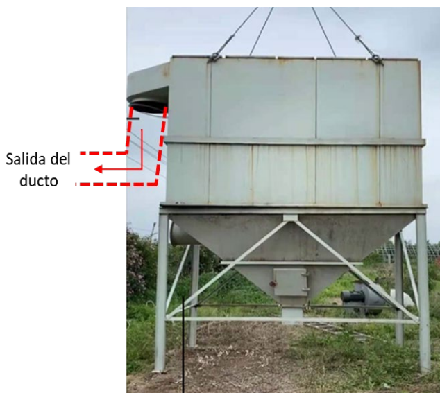
Figura 3. Punto de conexión del colector y el ducto
