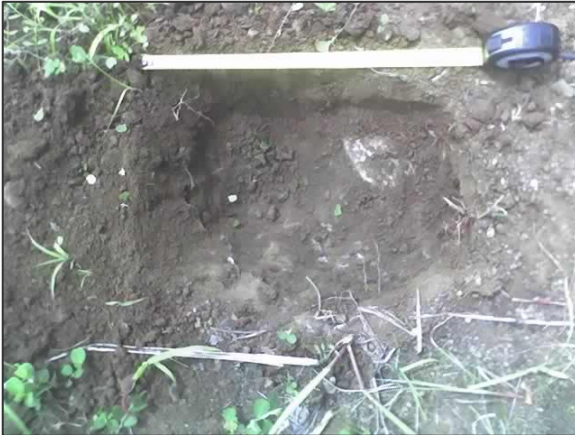
Foto 8. Se observa el sondeo 2, ubicado en las coordenadas de UTM: N999867, E659331. Al fondo se observa la aparición de la capa de rocas. Foto: A. Pérez Y.
