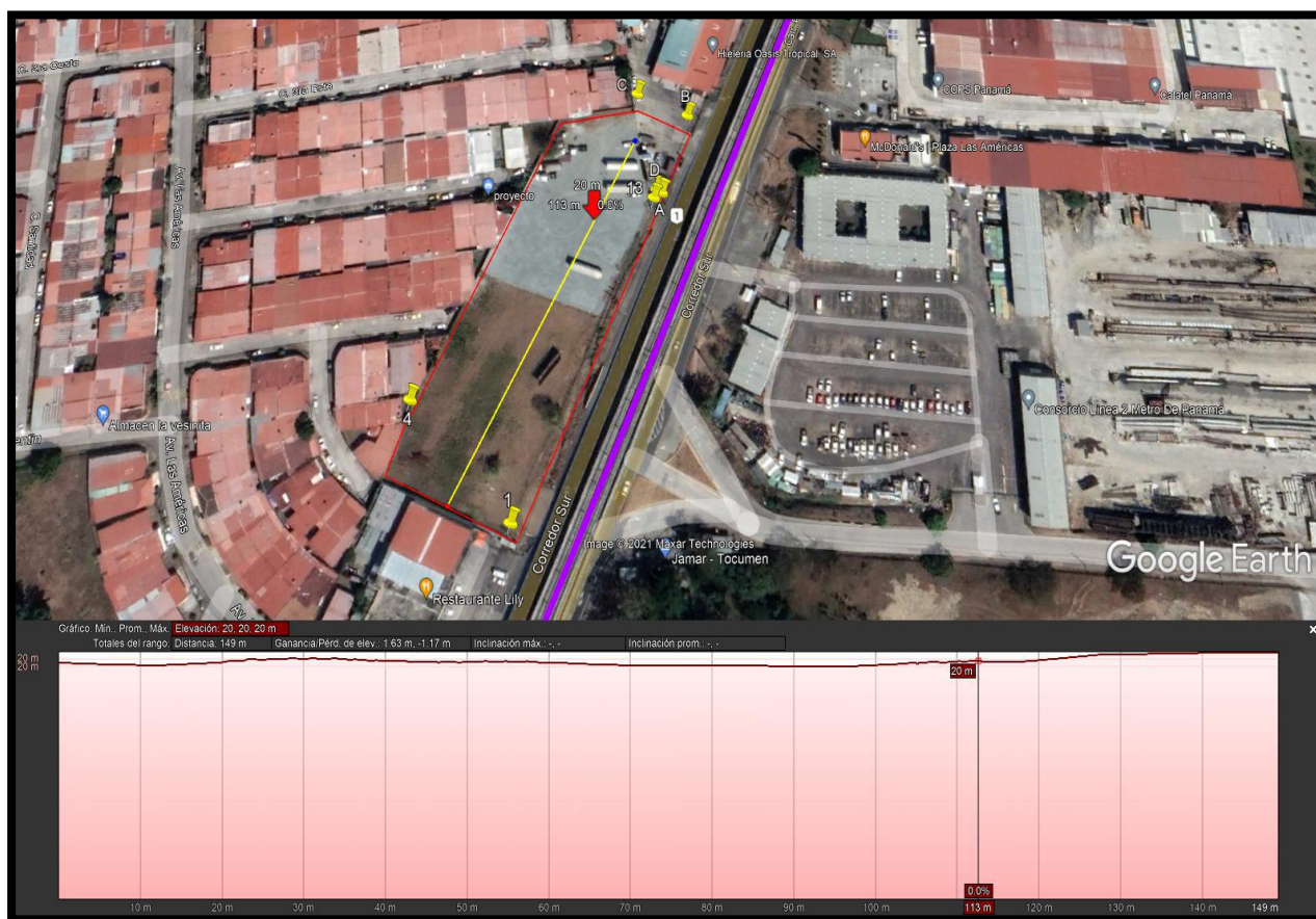
FIGURA 3. PERFIL DE ELEVACIÓN DE LA FINCA 279065.
