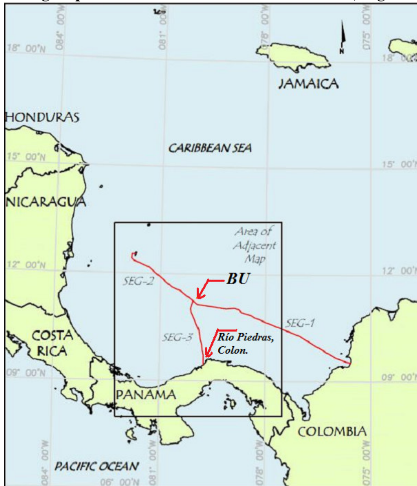
Figura No. 5 Ruta Elegida para la Instalación del Cable Submarino, Segmento 3.
