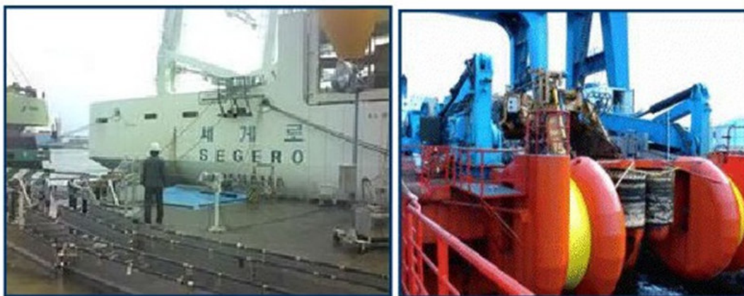
Figuras No. 3 y 4 Cargadores a bordo del barco de tendido.
