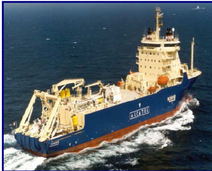
Figura No. 7 Ejemplo de embarcación a utilizar para el tendido del Cable Submarino
