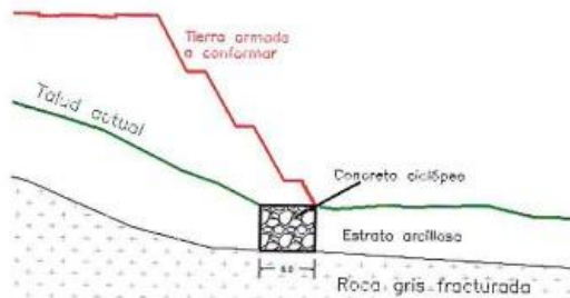
Figura 15 Esquema mejoramiento con concreto ciclópeo para rellenos superiores a 14.0 m El concreto ciclópeo se construirá por tramos a definir en conjunto con esta consultoría, con el fin de evitar inestabilidad en la pata de los taludes actuales.
