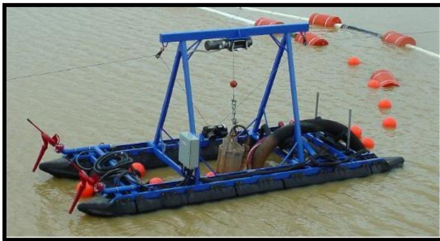
**Figura 3. PIRAHNA PUMP, Sistema de bombeo automatizado Dragado. Modelo P-50-A**
