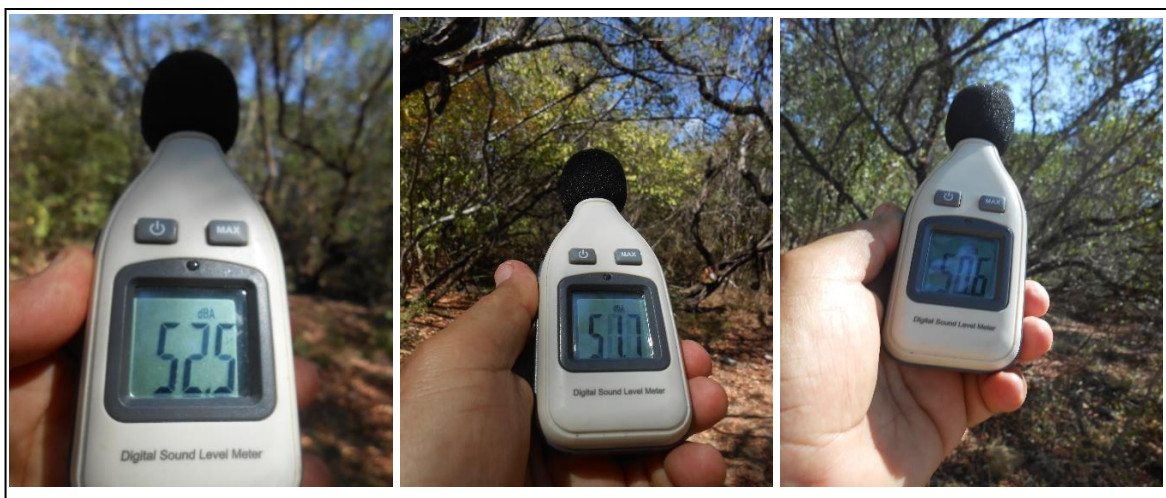
FIGURA 8 - Vistas Fotográficas que muestran el registro de las mediciones de ruido efectuadas.
