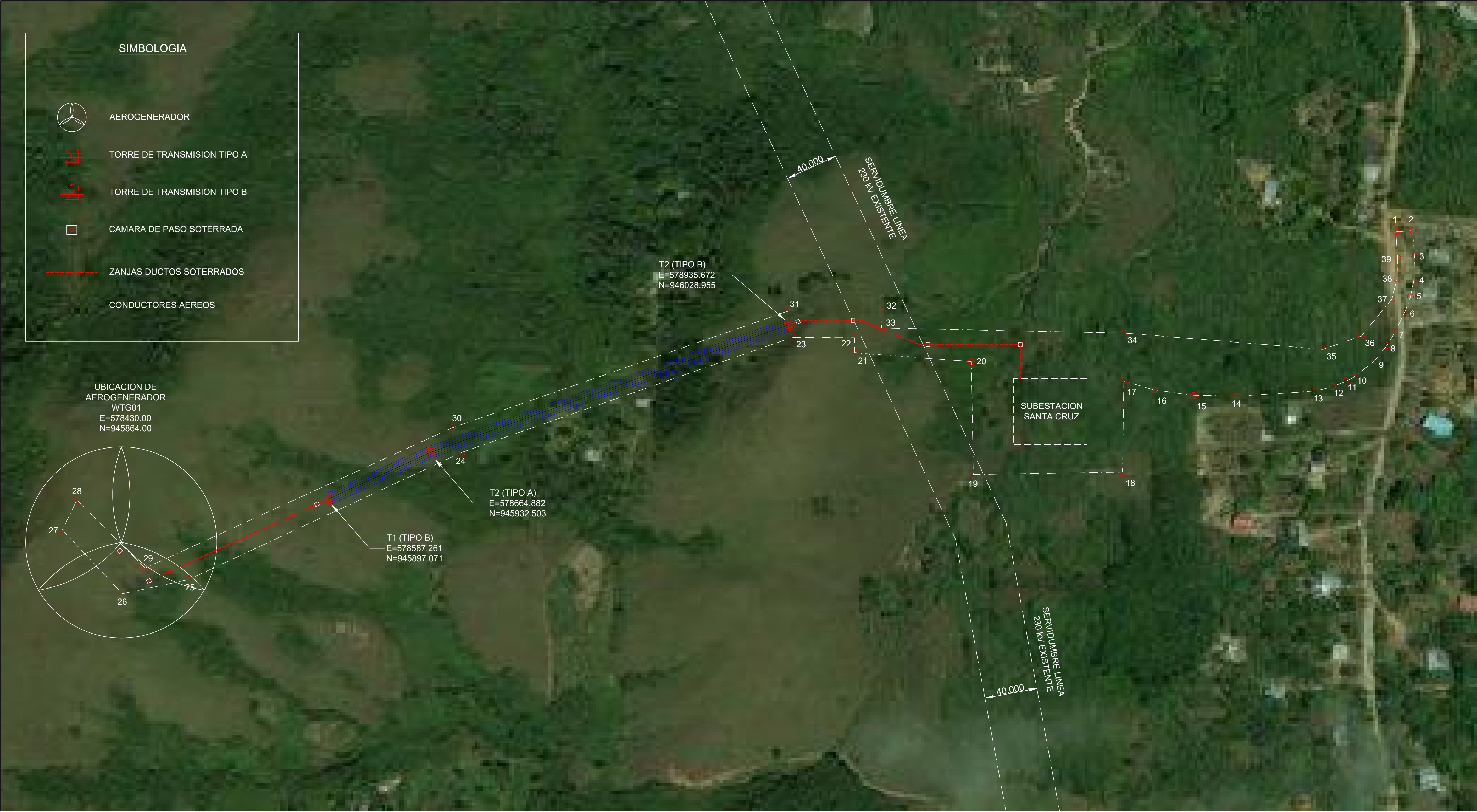
TRAYECTO DE LINEA DE EVACUACION 34.5 kV TRAMO AEROGENERADOR WTG01 - SUBESTACION SANTRA CRUZ
