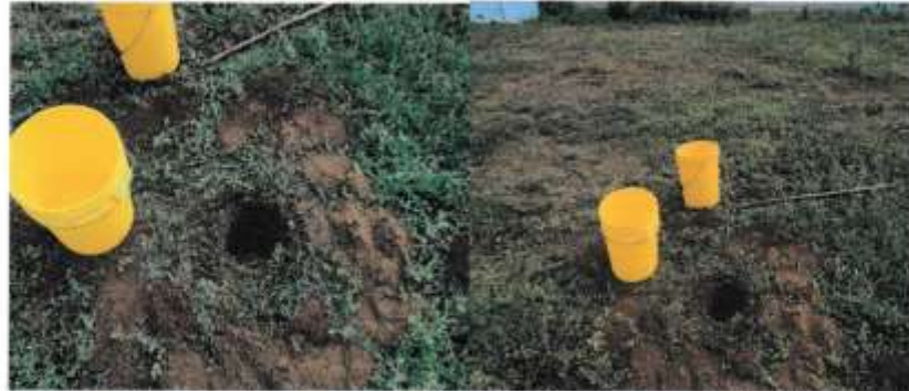
Inicio de las pruebas de percolación en los Locales Comerciales Hoyo No.1
