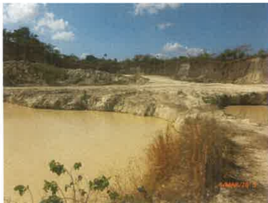
Tinas de decantación de sedimentos del proceso de lavado de arena continental.
