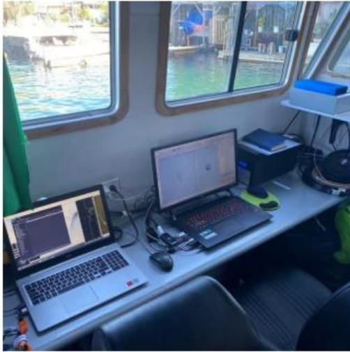
Computadores y Procesador MB/GNSS en embarcación.
