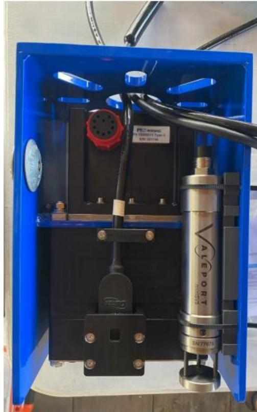
Arreglo IMU, MB y SVP en bracket.
