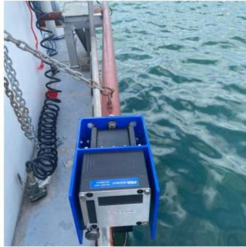
Transductor MB, IMU y SVP instalados.
