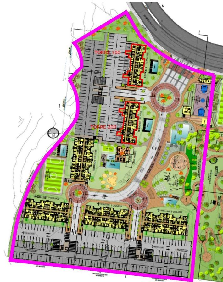
En sentido Norte -Sur, el terreno desciende desde el nivel de calle que se sitúa en 115 metros hasta el fondo del terreno que tiene una elevación aproximada de 100 metros. Siendo que la roca se encuentra a profundidades mayores a 30 metros no será necesaria la excavación en roca y las fundaciones recomendadas serán sobre pilotes vaciados en sitio de al menos 20 metros de longitud.
