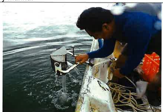
Foto 3. Colecta de muestras de Bentos, empleando draga Ekman
