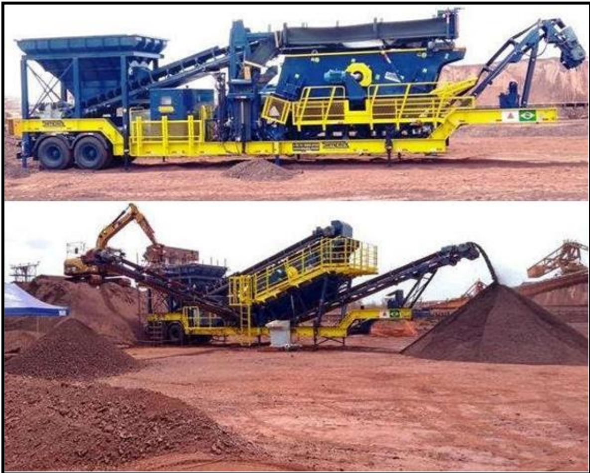
Figura 11. Modelo de trituradora temporal a utilizarse en el proyecto.
