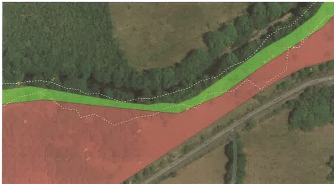
Figura N°4 La línea de puntos marca la zona de protección y los colores indican zona de construcción o zona de no intervención
